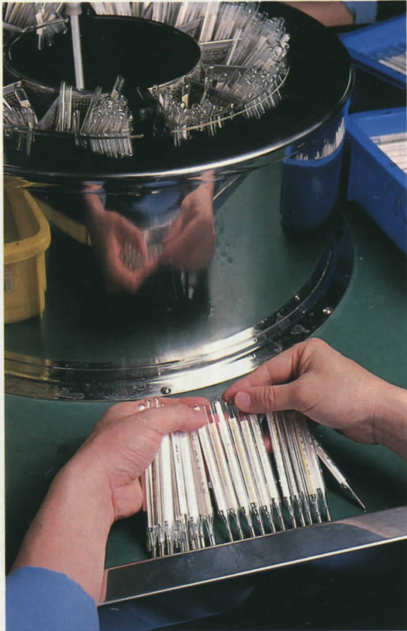
日本は世界最大の体温計生産国。都の計量検定所で1本ずつ精度検定を受ける水銀計。計量法の改正では、検定のメーカー移管も議論される
