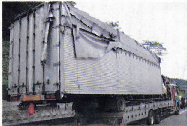
2008年6月に天井板に接触したトラック。大型貨物車に普通貨物車を積載したため、高さオーバーしていました(国交省の調査・検討委員会資料から)
