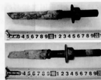
図5. 引き抜かれたアンカーボルト(国土交通省)
