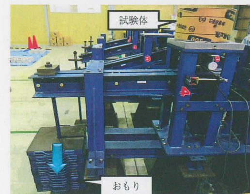
写真-4 クリープ載荷試験状況
