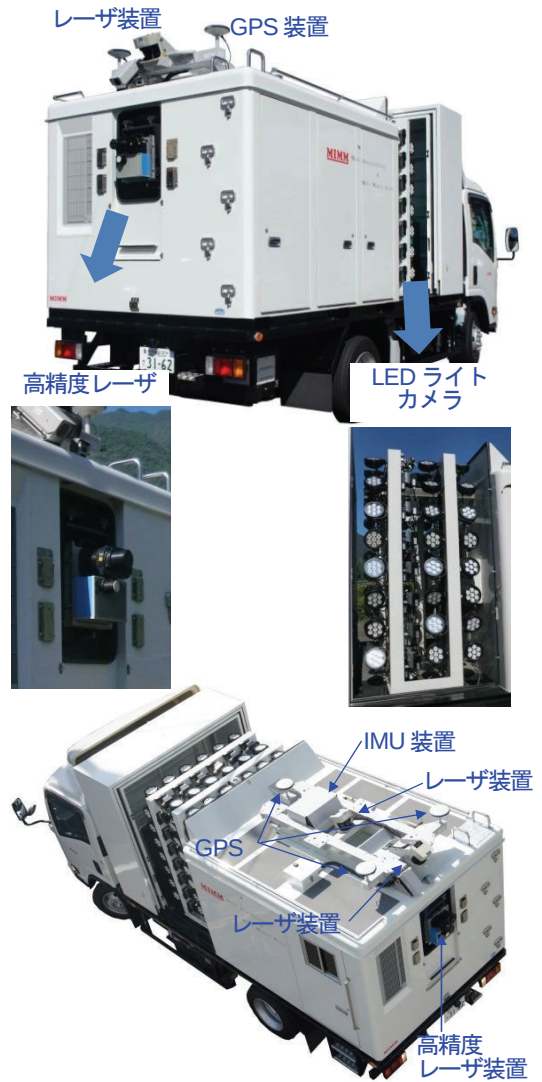
図-2 走行型計測車両(MIMM)写真 2)
